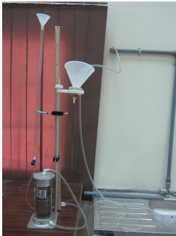
Fig. (9) Permeameter (Constant & Falling Head)
